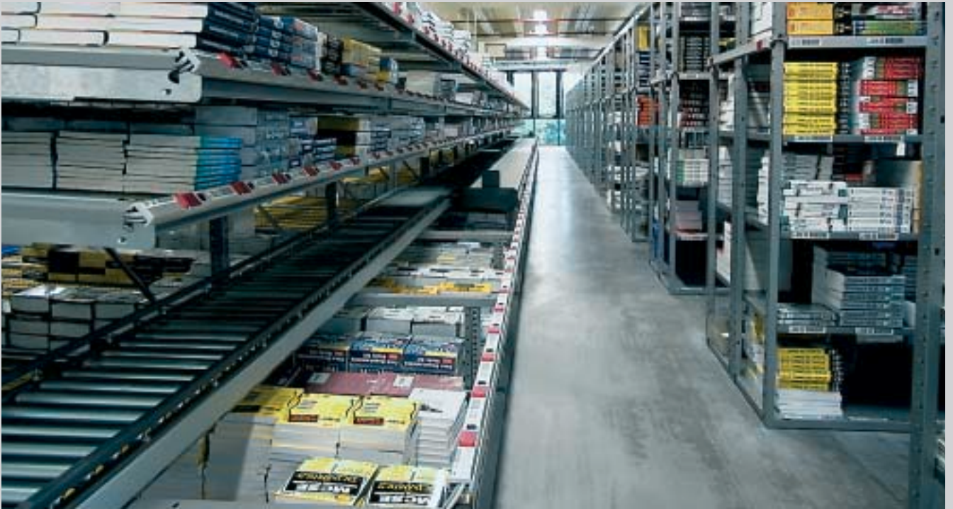
Scaffalatura a gravità KDR con sistema di movimentazione e Pick-by-light integrato, nel settore dell'editoria
