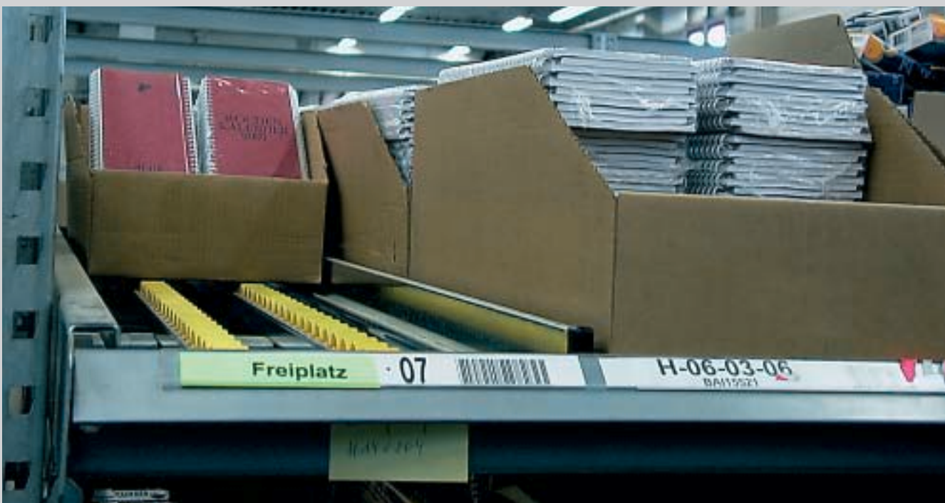
Canali a gravità con guide. Cartoni con apertura di prelievo migliorano l'accessibilità alla merce stoccata
