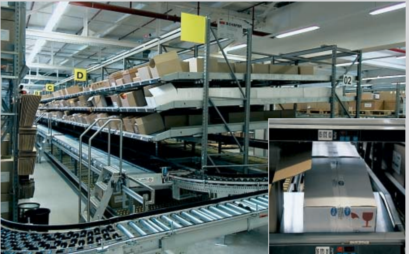
Scaffalatura a gravità KDR con sistema di movimentazione e Pick-by-light integrato, nel settore farmaceutico
