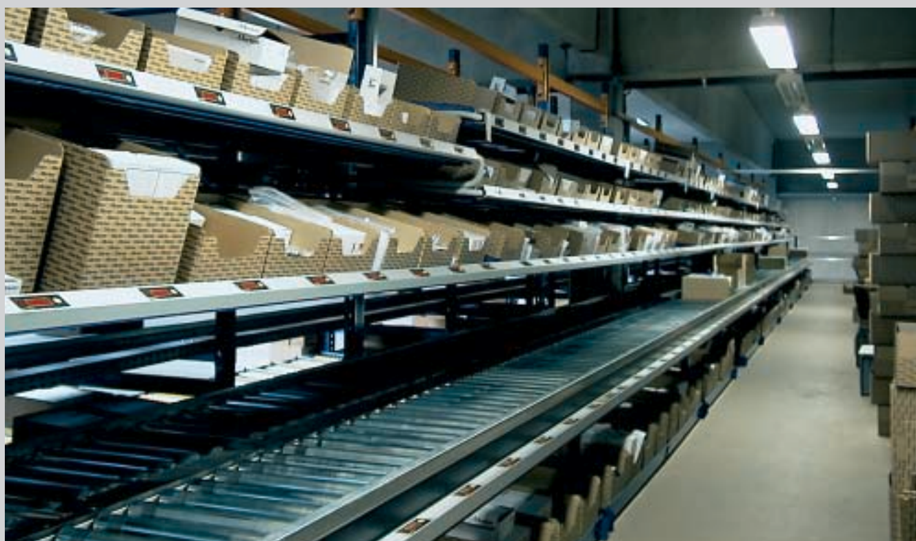
Scaffalatura a gravità per l'allestimento di articoli elettrici in cartoni con apertura di prelievo
