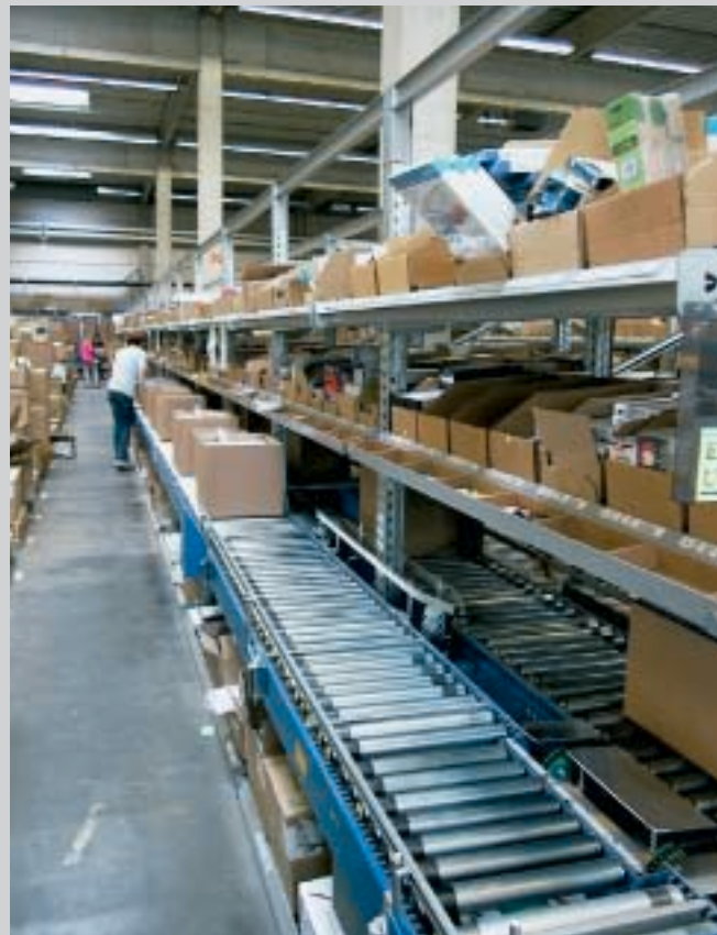
Scaffalatura a gravità KDR per articoli ufficio con sistema di movimentazione e ripiano superiore per deposito di quantità in eccesso
